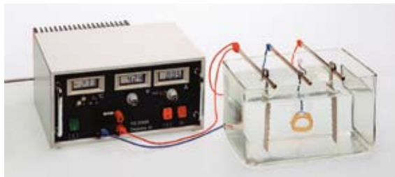
Kleinanlage für Goldschmiede für den galvanischen Überzug von Schmuck. BILD: UBOS
