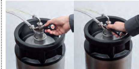
Den Hebel herausziehen, nach unten drücken und einrasten. Dadurch werden die Ventile für Bier und Ausschankgas geöffnet, und es kann gezapft werden. Bei einigen Zapfköpfen muss zusätzlich ein Absperrventil geöffnet werden, damit das Bier fließt.
