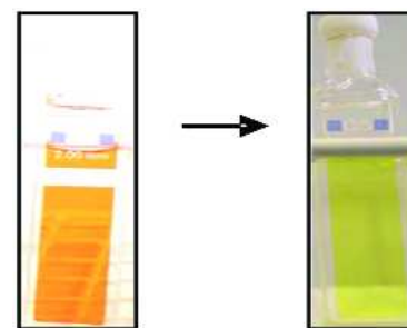
Abb. 4: Pigment Red 22 (PR 22), gelöst in THF. Farbveränderung von orange nach gelb nach 150 min UVB-Bestrahlung (13,5 J/cm 2 )
