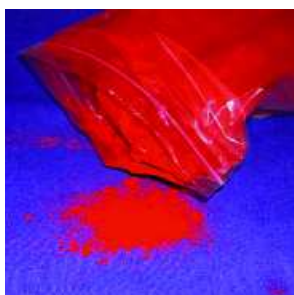
Abb. 3: Der rote Naphthol-AS-Farbstoff Pigment Red 22 (PR 22)
