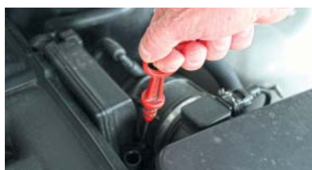
Der Motor sollte einige Minuten vor der Niveau-Kontrolle abgestellt werden, damit sich das Öl in der Ölwanne sammeln kann.
