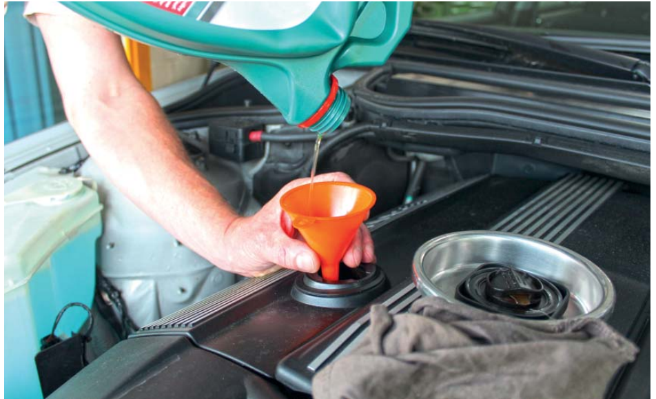
Nicht zu viel Öl auf einmal einfüllen, zwischendurch das Niveau mit dem Ölmesstab kontrollieren. Ein zu hoher Ölstand ist zu vermeiden. Darauf achten, dass der Öldeckel nicht neben dem Motor herunter in den Dreck fällt.
